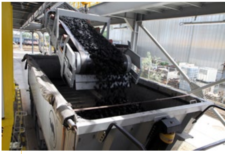
Jeszcze w czerwcu w „Piaście” ruszy zautomatyzowane stanowisko do szybkiego załadunku orzecha i kostki z dwoma stutonowymi zbiornikami na węgiel.
