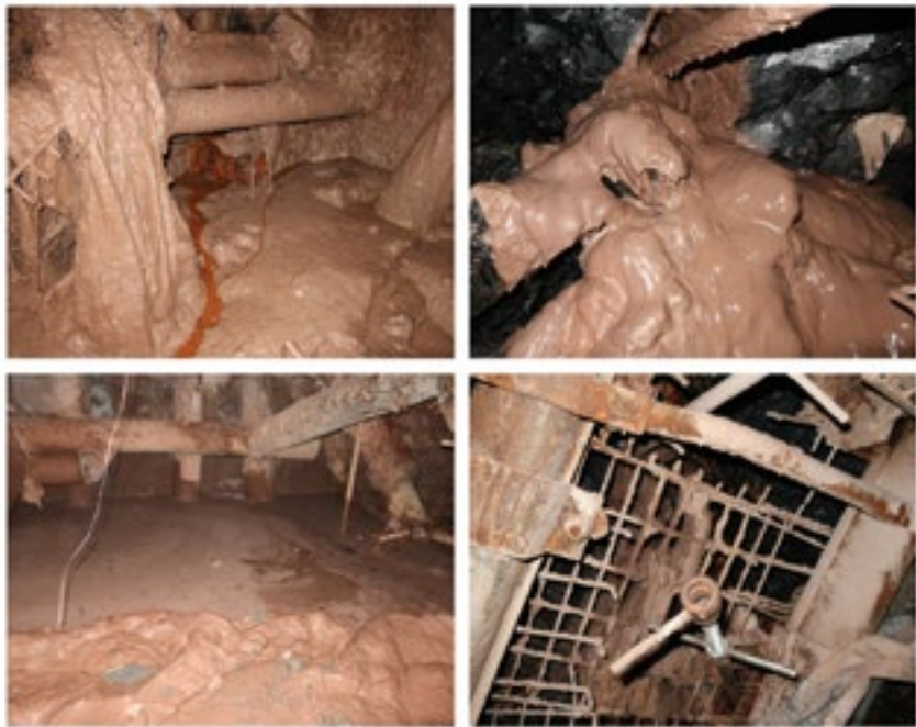
FOT. 1. Spoiwo hydroizolacyjne
